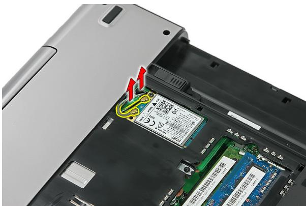
5. WWANカードを固定しているネジを外します。
