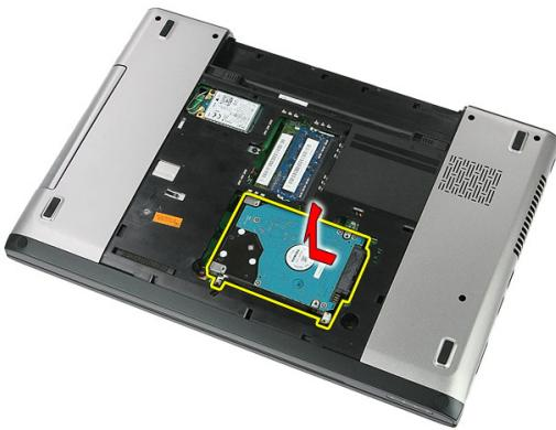
6. ハードドライブブラケットをハードドライブに固定しているネジを外します。
