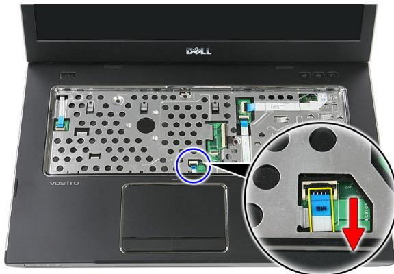
11. クイック起動ボタン基板ケーブル固定クリップを解除します。
