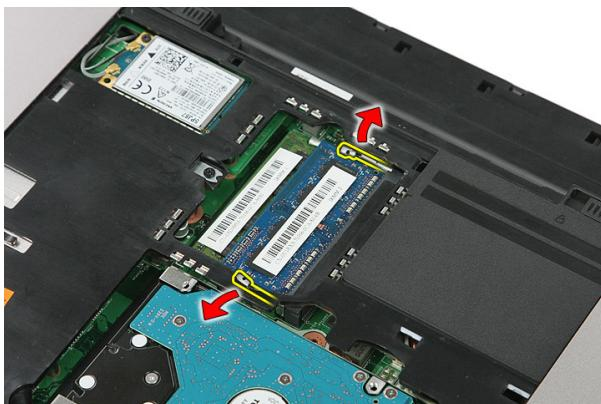
5. メモリーモジュールをシステム基板のコネクターから取り外します。
