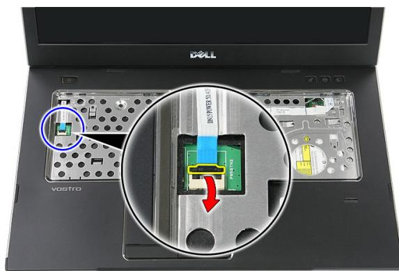
8. 電源ボタン基板ケーブルを取り外します。
