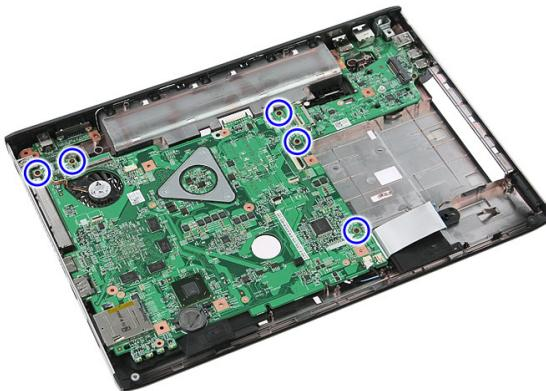
17. システム基板を斜めにして持ち上げ、取り外します。
