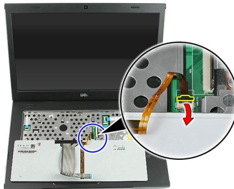
8. コンピューターのキーボードにバックライトが存在する場合、キーボードのバックライトケーブルを外します。
