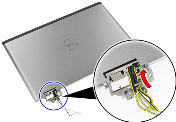
14. ディスプレイブラケットとヒンジをディスプレイアセンブリに固定しているネジを取り外します。
