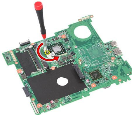
17. プロセッサーを持ち上げ、取り外します。
