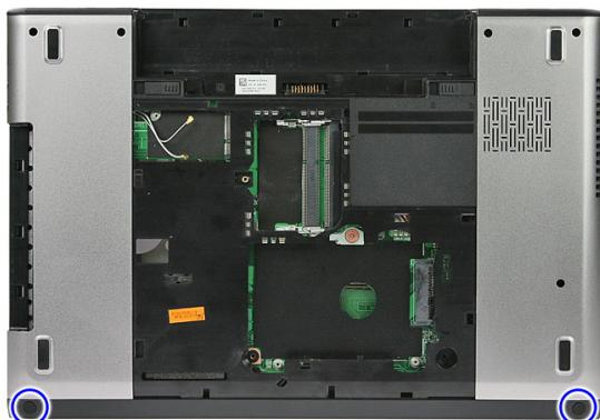
6. コンピューターにパームレストを固定しているネジを外します。
