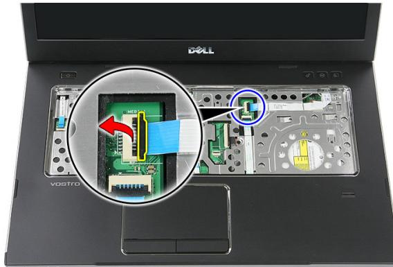
12. クイック起動ボタン基板ケーブルを取り外します。
