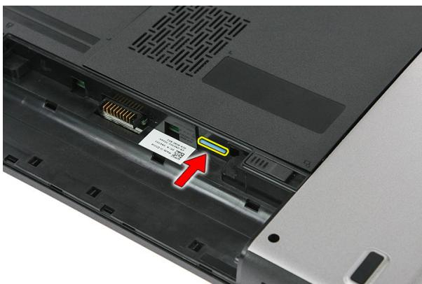
4. SIM カードを持ち、コンピューターから引き抜きます。
