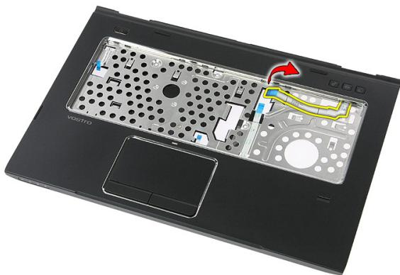
7. クイック起動ボタン基板を固定するネジを取り外します。
