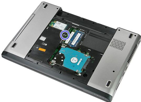
5. ドライバーを使って、オプティカルドライブをゆっくりと動かし、コンピューターから取り外します。
