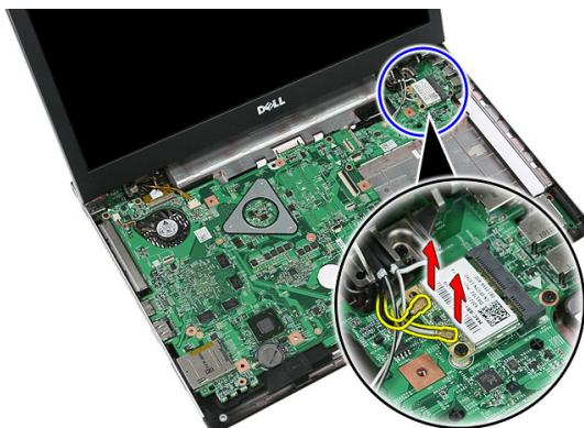
7. WLAN カードを固定しているネジを外します。
