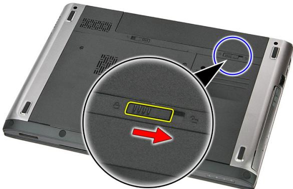
3. バッテリーをスライドさせて、コンピューターから取り外します。
