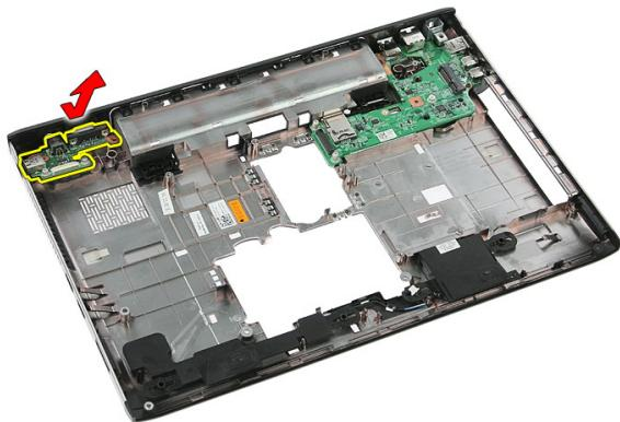
18. 右の I/O 基板を固定しているネジを外します。
