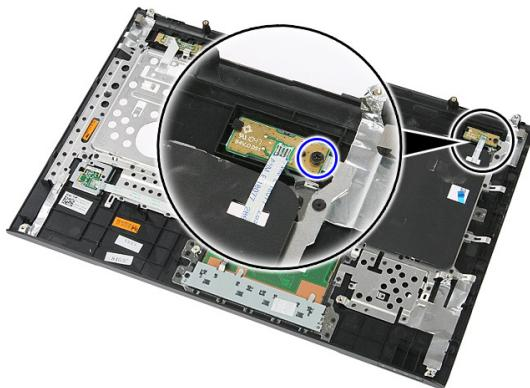
8. ラッチを持ち上げ、電源ボタン基板を解放し、次に持ち上げて取り外します。
