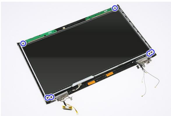
15. ブラケットおよびヒンジの付いたディスプレイパネルを持ち上げて取り外します。
