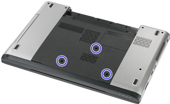
4. アクセスパネルを斜めに持ち上げ、コンピューターから取り外します。
