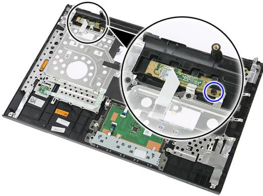
8. クイック起動ボタン基板を持ち上げ、取り外します。
