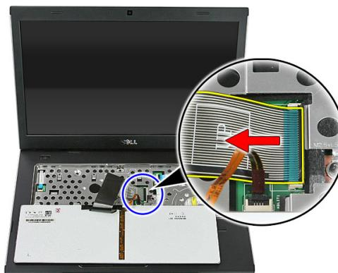
7. コンピューターのキーボードにバックライトが存在する場合、キーボードのバックライトケーブル固定クリップを開きます。
