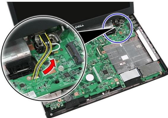
10. システム基板からディスプレイデータケーブルを取り外します。
