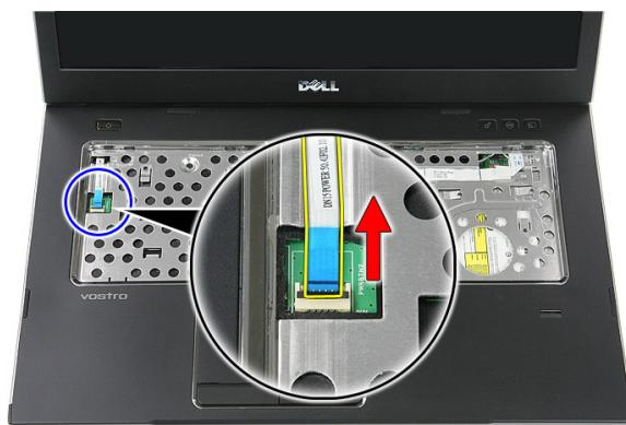
9. タッチパッドデータケーブル固定クリップを外します。
