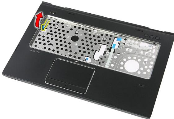
7. 電源ボタン基板を固定しているネジを取り外します。
