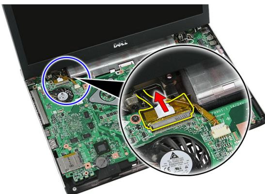
11. コンピューターにタッチパネルが存在する場合、タッチパネルのケーブルを取り外します。
