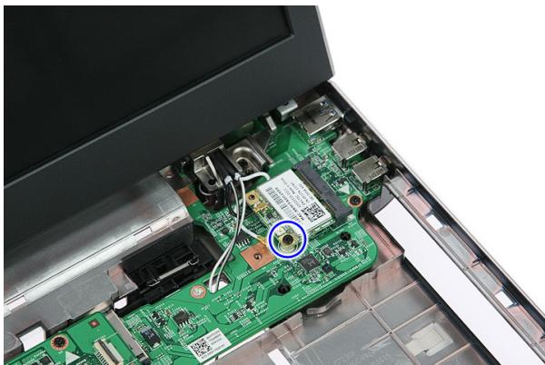
8. WLAN カードをコンピューターから取り外します。
